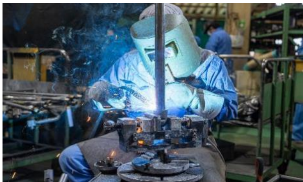
CO 2 半自動溶接
