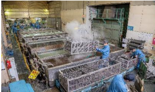
洗浄槽(8連槽) (1m x 4m x 1m)
